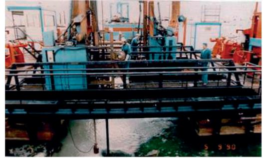
Double chariot de forage sur plateforme élévatrice en configuration marteau hors de trou
