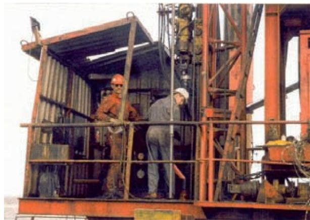
*Plateforme élévatrice comportant une foreuse élévatrice et une glissière télescopique*
