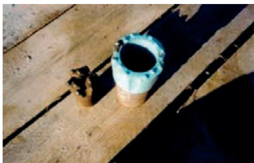
Taillant annulaire de pré-tubage 114 mm et taillant de forage 70mm
