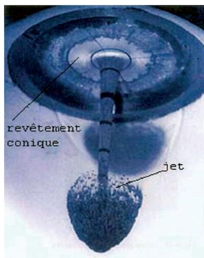
*Vue de la partie inférieure du cône durant la détonation de la charge*
