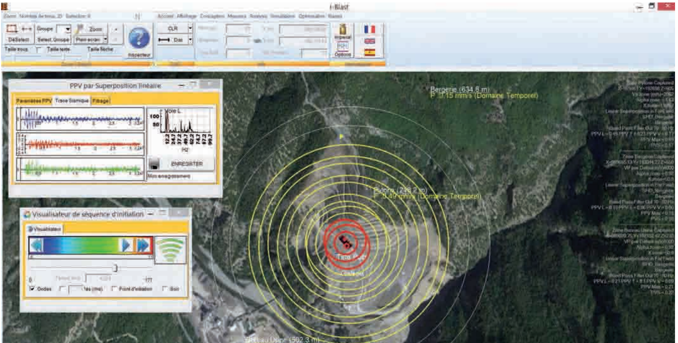
Exemple d'écran d'un logiciel : entrée des données, simulation des niveaux de vibration et courbes granulométriques (simulées et mesurées)
